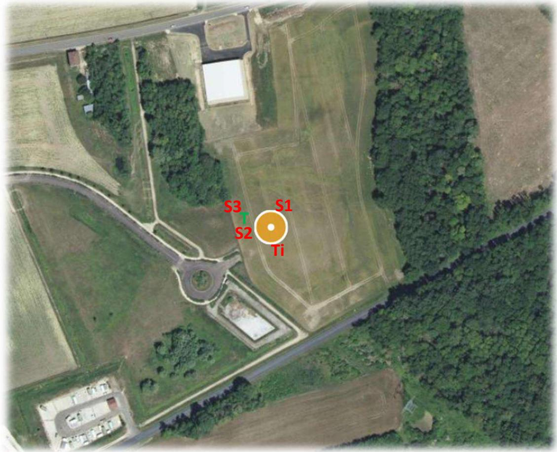
Figure 7 : Implantation des sondages et des tests de perméabilité
